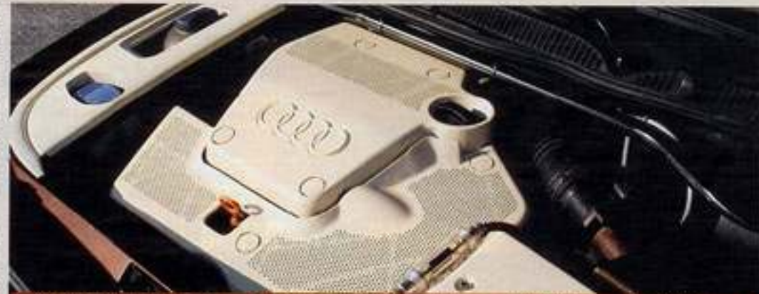
Der optisch veredelte Motor wurde bisher bei seiner Serienleistung von 101 PS belassen. Die Abdeckungen des 1,6ers wurden lediglich in Braun und Beige lackiert. Die Domstrebe stammt vom Audi S3
