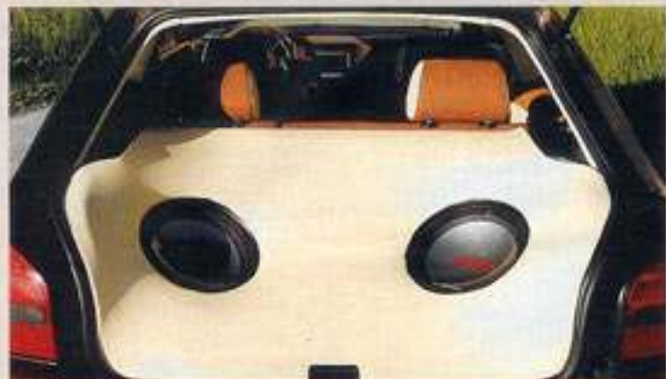
Koffer(t)raum: Im ehemaligen Gepäckabteil hausen jetzt zwei SWR-Subs und versteckte ICE (In-Car-Electronic) unter der beige Abdeckung
